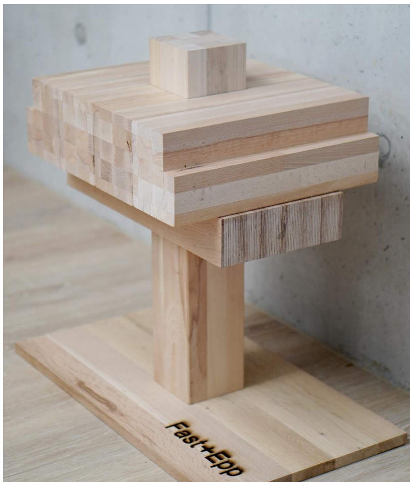
Abbildung 88: Modell des Stützenknotens Konzept 2
