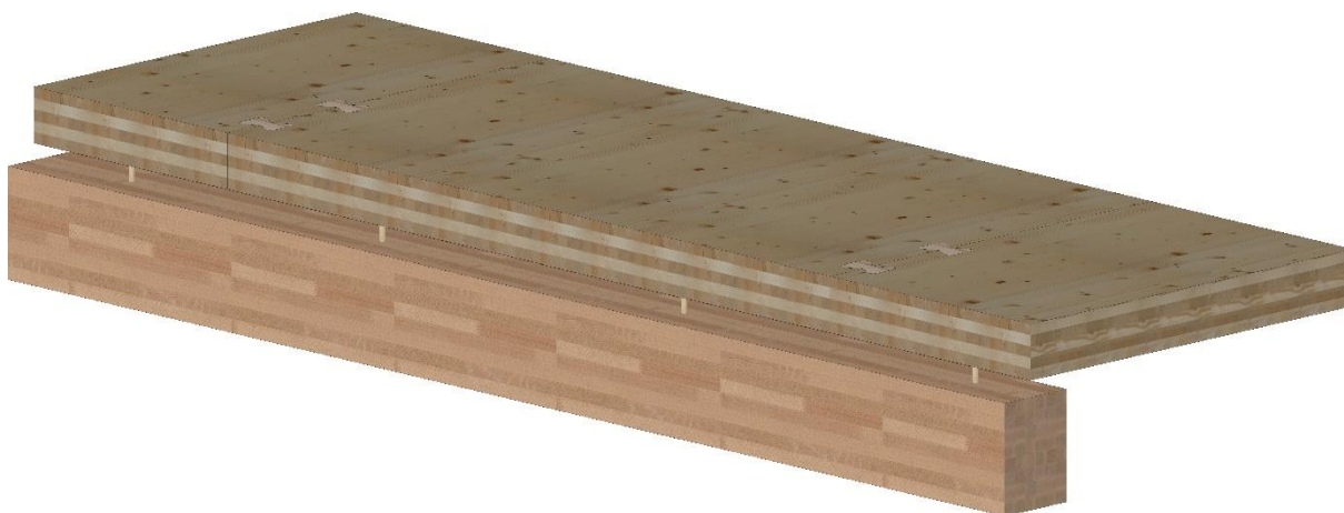
Abbildung 73: Anschluss Decke an Unterzug mit Holzdübeln
