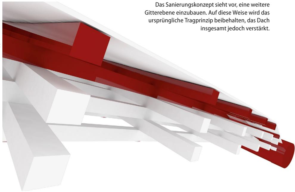
Das Sanierungskonzept sieht vor, eine weitere Gitterebene einzubauen. Auf diese Weise wird das ursprüngliche Tragprinzip beibehalten, das Dach insgesamt jedoch verstärkt.
